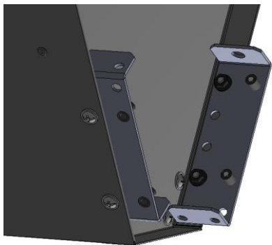
Монтаж крепежа GUARD PRO внутри завесы
